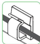
Posizionare il cavo di connessione della penna per lamina a caldo sul fermacavo.
